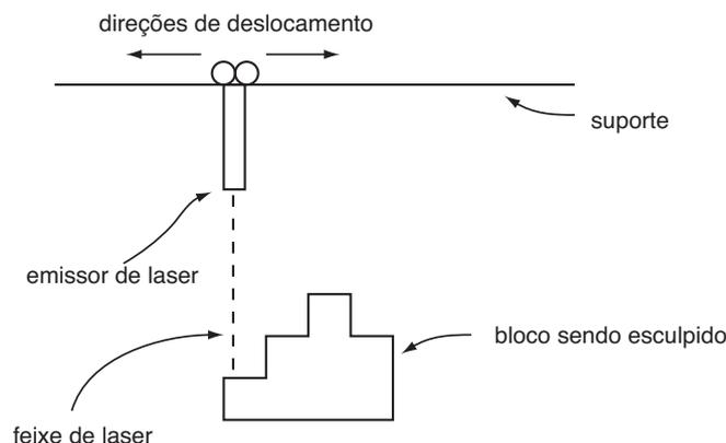
A figura acima mostra um diagrama esquemático de um equipamento para esculpir, com laser, um bloco de material maciço. Na figura vemos um emissor laser que se desloca horizontalmente para a direita e para a esquerda com velocidade constante. Quando o emissor é ligado durante o deslocamento, uma camada de espessura constante é removida do bloco, sendo vaporizada pelo laser.
